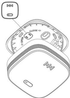
Montáž detektoru podle zarovnání - pohled ze strany
