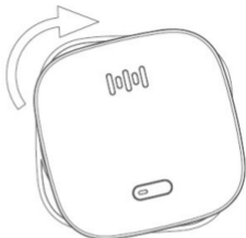
Montáž detektoru podle zarovnání - čelní pohled
